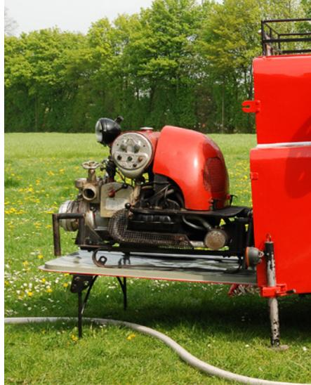
TS 8/8 (Tragkraftspritze) Bild: Wilfried Deckers
